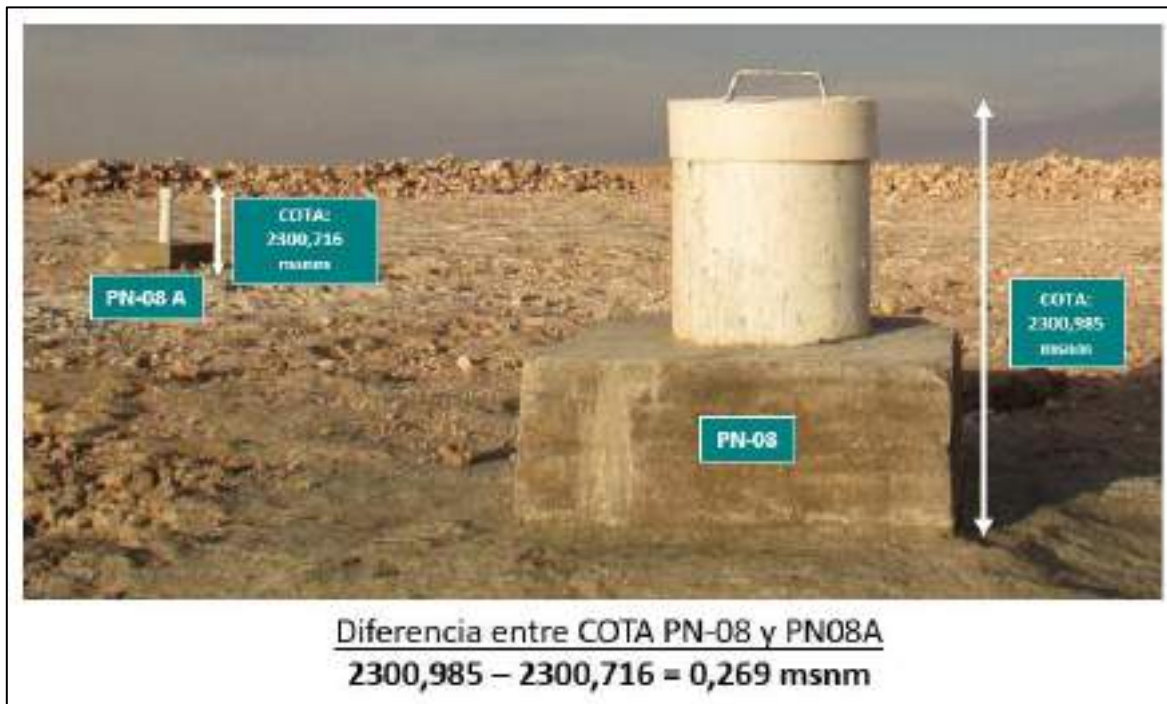
Figura 4: Vista de puntos de monitoreo plataforma PN-08A
