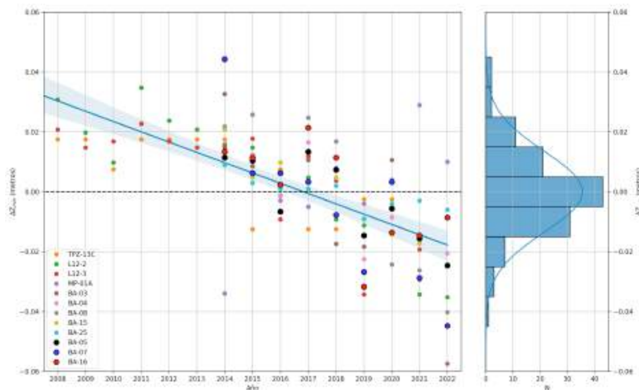
Figura 6. (izquierda) Series de tiempo de las anomalías del nivel mínimo anual de todos los puntos de monitoreo del sistema La Punta - la Brava. La línea azul muestra el ajuste lineal para la tendencia de largo plazo. El área azul muestra el rango de confianza 95% de dicho ajuste. (derecha) Distribución de las diferencias entre las anomalías individuales del ajuste lineal. La línea azul indica el ajuste a una distribución normal con promedio 0 y desviación estándar 13.5 mm.
